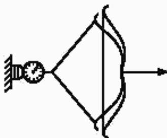
Рисунок 2 — Схема измерения силы дуг лука
