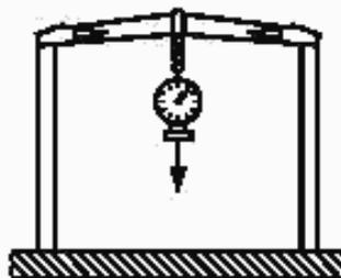
Рисунок 3 — Схема проверки рукоятки лука на прочность
